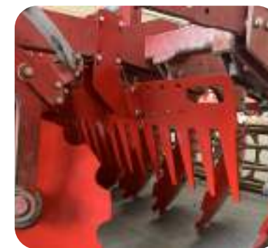
Peignes placés entre les rangées de disques ou entre les disques et le rouleau pour freiner le flux de terre et l'émietter (option).
