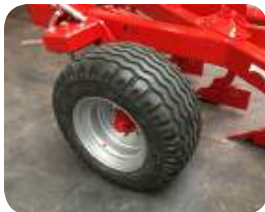
Rueda trasera de control y transporte. De gran facilidad de uso. Basta cambiar un bulón de posición. Sin necesidad de bloquear topes o soltar amortiguadores
