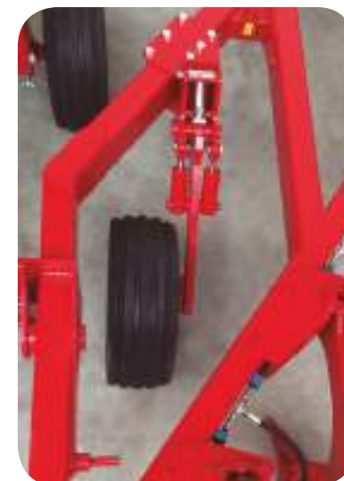
Rueda de control interior (solo para Mini-N base 7 y 9)
