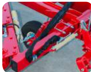
Regulación hidráulica del primer cuerpo
