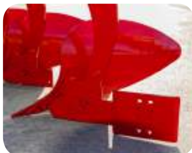
Taloneras para mejorar la estabilidad de la máquina
