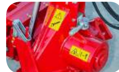
Bloqueo de cabezal para transporte en posición mariposa
