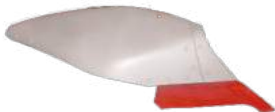
V-34: Trupiță universală pentru toate tipurile de sol. Inversarea solului cu cerințe limitate de putere a tractorului. Pentru adâncimi între 15 și 35 cm.
