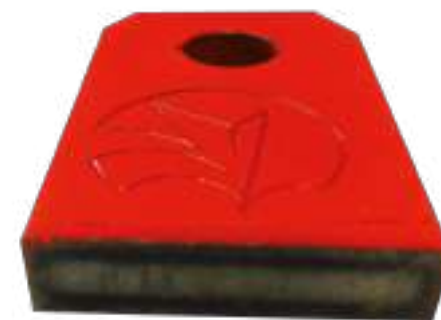
Cormane cu grosime de 8 mm – durată de viață mai lungă. Călire superficială (Case-hardening) crește duritatea suprafeței (peste 62 HRC) pentru o durată de viață mai lungă, menținând în același timp un miez moale și flexibil.
