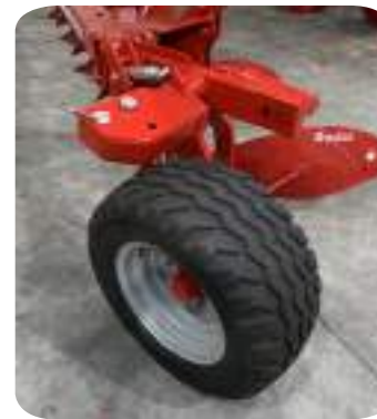
Roată spate de control și transport 340/55 16"
