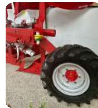
Roată spate de control hidraulică 280/70 16"
