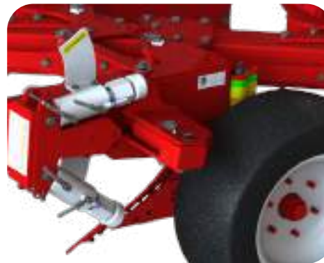
Gama de roți hidraulice include cilindri superiori și inferiori combinați cu casete de oprire.
