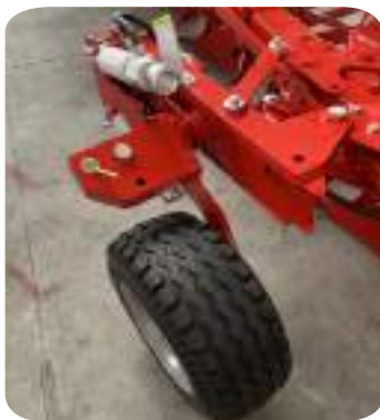
Roată multifuncțională hidraulică de transport și control 340/55 16"
