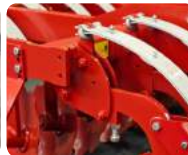
Discos de 24" (610 mm) y 6mm de espesor. Montados en brazos independientes de acero ALE / 24"
