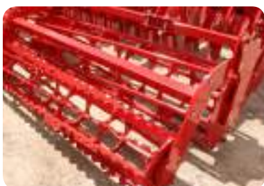
Rodillo Tandem de barras 480 mm + rodillo de muescas 400 mm (150kg/m)
