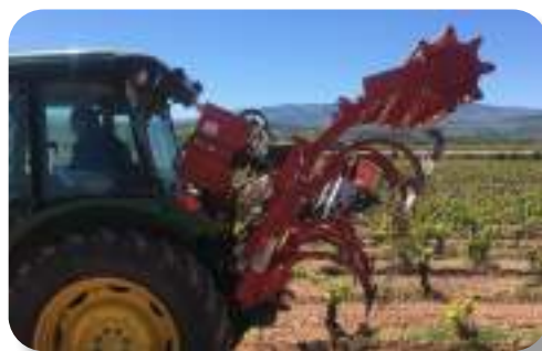
Chasis plegable hidráulicamente. Cilindro con rótulas y válvula Over Center.
