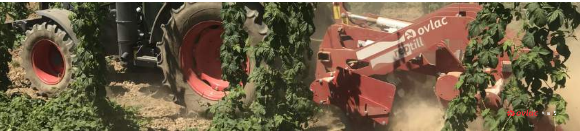
Chasis elevable hidráulico para una mejor maniobrabilidad en los cabeceros.
