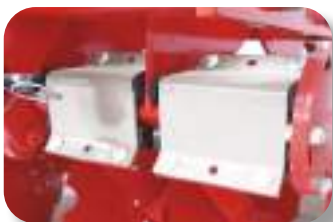
Sistema Non Stop por elastómeros con resaltes anti-extrusión.
