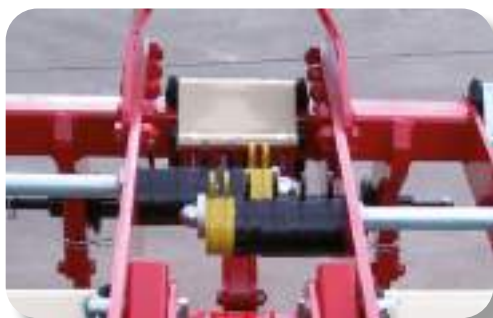
Chasis telescópico manual en lugar de hidráulico. Gran facilidad y comodidad gracias al sistema de clips.
