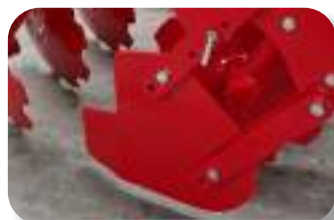
Placas limitadoras laterales con paralelogramo.
