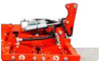
Chasis elevable hidráulico para una mejor maniobrabilidad en los cabeceros.
