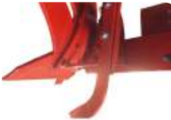
Versoir Claire-Voie pour les terres collantes. Déflecteurs qui améliorent l'enfouissement des débris
