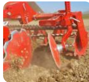
Disco de borde izquierdo para cerrar el surco formado por el disco trasero izquierdo (opción).
