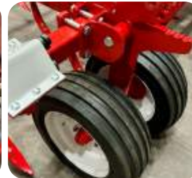
Ruedas delanteras dobles 200/60 14.5" replegables hidráulicamente para el transporte (de serie).
