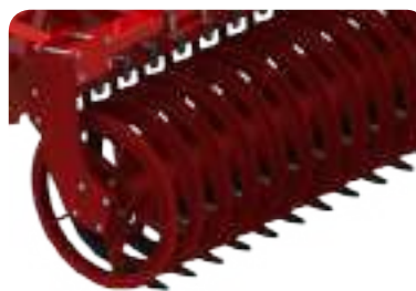
Rodillo de aros T o U 520 mm (140kg/m)
