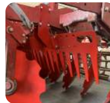
Peines colocados entre las filas de discos o entre los discos y el rodillo para frenar el flujo de tierra y desmenuzarla (opción).
