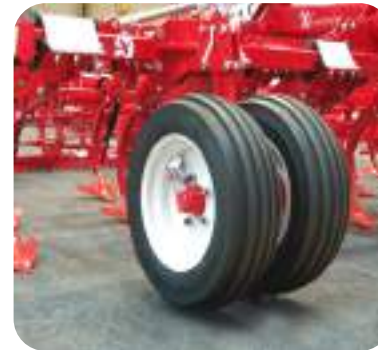
Ruedas delanteras dobles 200/60 14.5".
