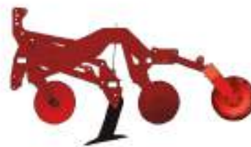
Les dents de 600 mm peuvent descendre jusqu'à 25 cm en dessous de la profondeur de travail des disques.
