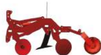
Les dents de 600 mm se relèvent à 18 cm au-dessus des disques.
