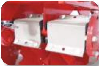
Système Non Stop à base d'élastomères avec reliefs anti-expulsion.
