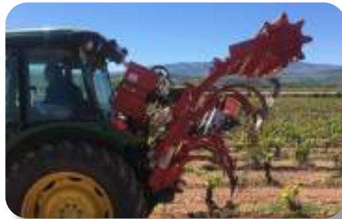
Châssis repliable hydrauliquement. Vérin avec rotules et valve Over Center.
