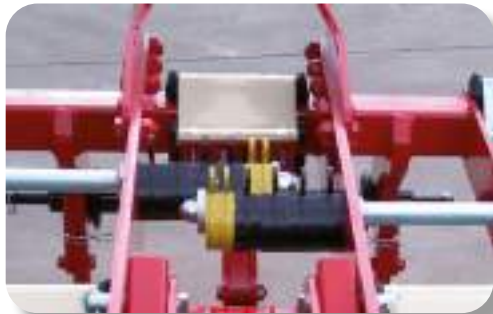
Châssis télescopique manuel au lieu d'hydraulique. Grande facilité et confort grâce au système de clips.
