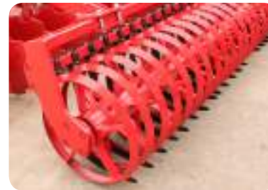
V-Ring-Walze 600mm (130 kg/m)
