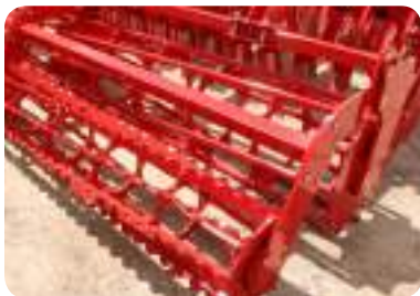
Tandemwalze: 480-mm-Krebbblechwalze + 400-mm-Stabwalze (150 kg/m)
