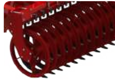
Tandemwalze: 480-mm-Krebbblechwalze + 400-mm-Stabwalze (150 kg/m)
