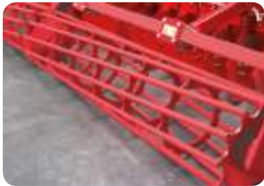
Stabwalze 480 oder 540 mm (80/90 kg/m)
