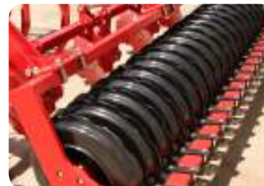
600mm V-Profil-Walze (210 kg/m)
