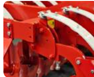
24" (610 mm) Scheiben und 6 mm Dicke. Montiert auf unabhängigen Armen aus HEL-Stahl / 24"
