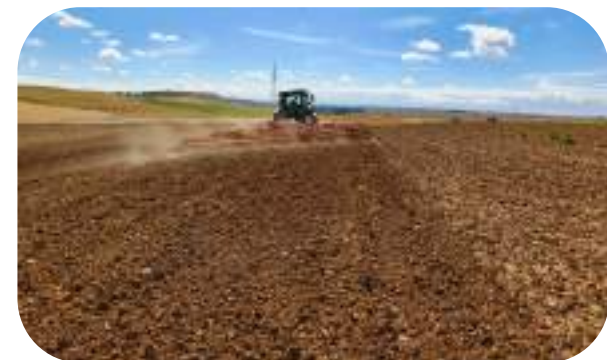
Perfektes Finish, typisch für einen Saatbettgrubber, dank den Nivellierzinken und der hinteren Walze.
