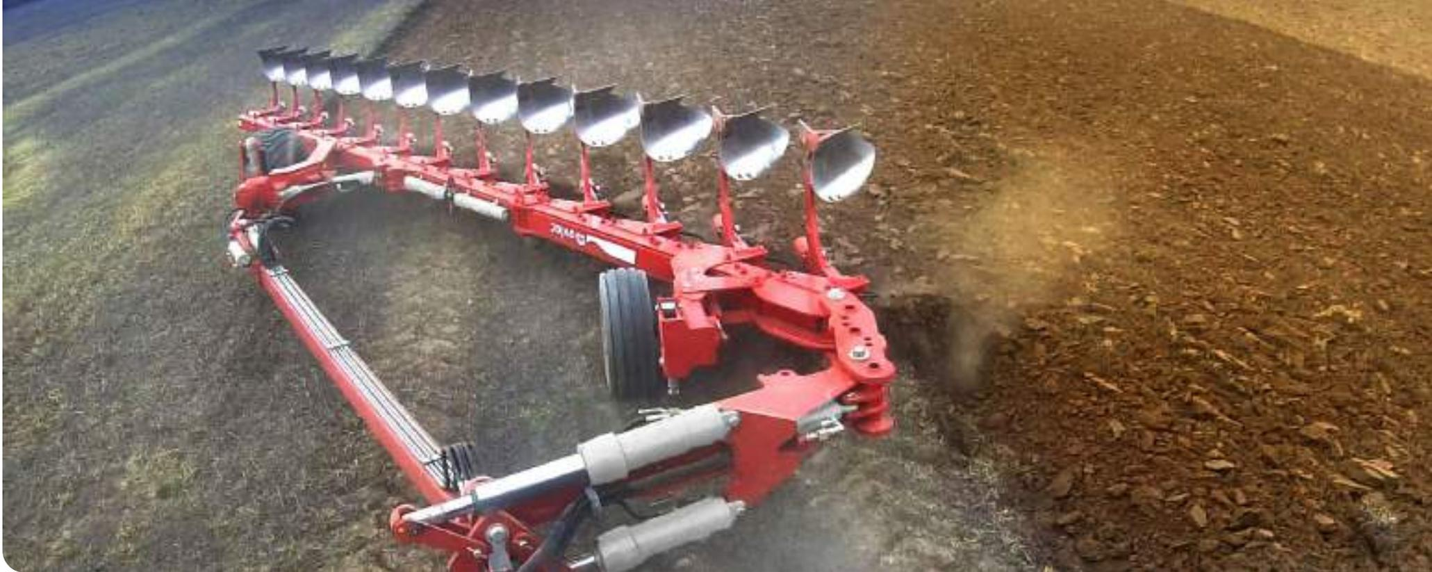
Al igual que la versión suspendida, el **Mini SF/SH** está disponible con seguridad por tornillo fusible o con seguridad Non Stop hidroneumática de presión de disparo regulable en función de las condiciones del terreno.
