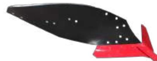
**V-PLAST:** indicado en terrenos muy pegajosos y sin piedra. Misma geometría que el cuerpo V-90 o V-97.
