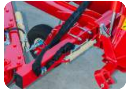
Hydraulische Hangverschiebung der Vorderfurche
