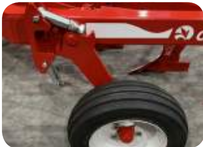
Verschiedene Stützrad verfügbar 6.00*9"; 200/60; 250/65; 340/70 und 380/55
