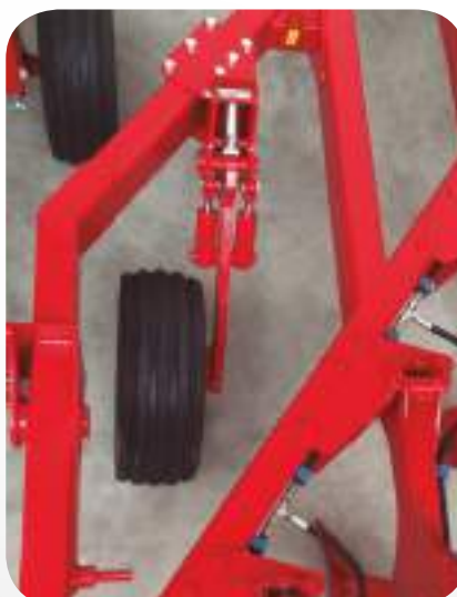
Inneres Steuerrad (nur für Mini-N Basis 7 und 9)
