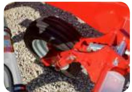
Roue de contrôle avant. Disponible en 6.00\*9", 200/60, 250/65 (según modelos)
