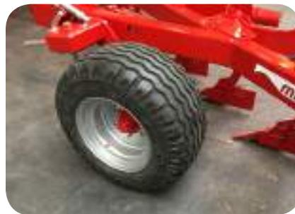
Roue arrière pour le contrôle et le transport. Très facile à utiliser, il suffit de changer la position d'un boulon. Il n'est pas nécessaire de bloquer les arrêts ou de libérer les amortisseurs.
