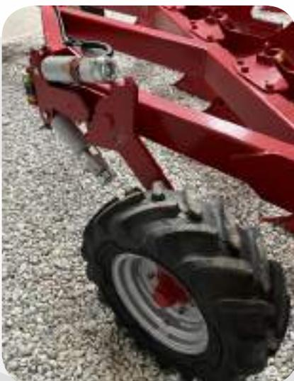
Roue de contrôle et transport hydraulique 280/70 R16
