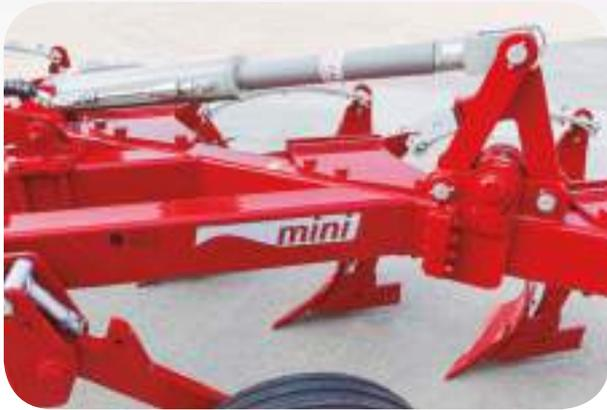
Tout comme la version réversible, la gamme de Mini à planche se compose en 3 bases : 6, 8 et 10 corps. Chacune de ces bases peut recevoir 1 ou 2 corps supplémentaires, soit fixes ou à repliage hydraulique pour réduire le porte à faux et la longueur de la charrue.
