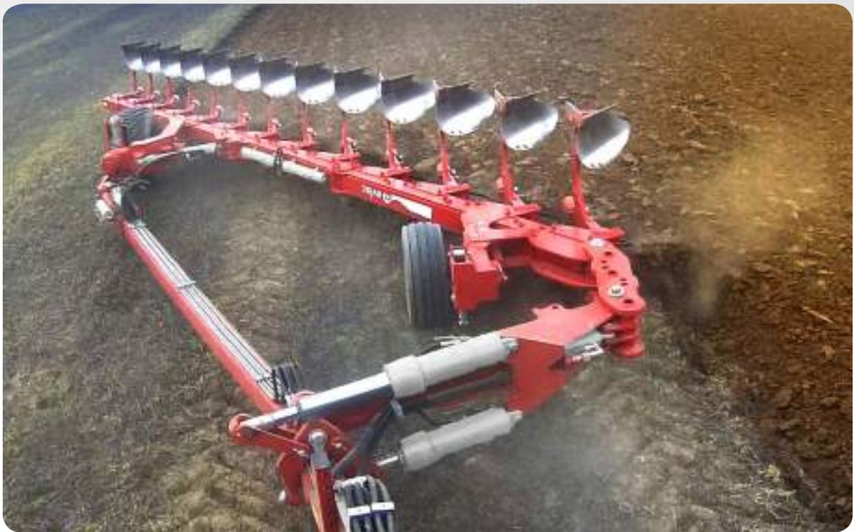
Al igual que la versión suspendida, el **Mini-NS** está disponible con seguridad por tornillo fusible o con seguridad Non Stop hidroneumática de presión de disparo regulable en función de las condiciones del terreno.
