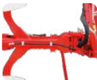
Corps X-Light 25 kg plus léger que le standard (max. 32 CV par corps).
