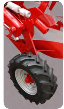
Hydraulische Steuerung des Hinterrads 280/70. (Radial)
