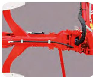
Grindel X-Light 25 kg leichter als Standard (max. 32 PS pro Körper). nur für Serie 130 verfügbar.
