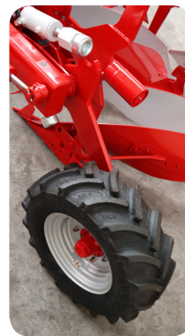
Rueda trasera de control hidráulico 280/70. (Radial)
