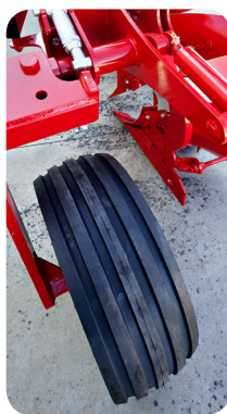
Rueda trasera de control y transporte 250.
