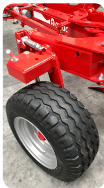
Rueda adelantada de control y transporte 340.
