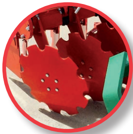
Discos de 20" (510 mm) en 6 mm de espesor.
