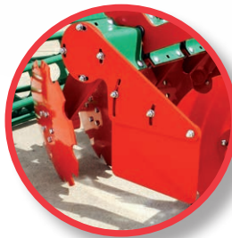
Placas laterales regulables en altura e inclinación.
