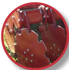
Discos adicionales atornillados. Additional bolt-on side discs.
