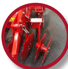
Conjunto de 2 discos exteriores traseros. 2 outer discs rear position
