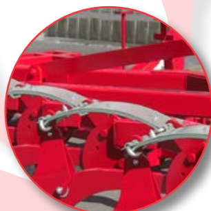
Sécurité à lames de ressort Mini-BF/HF
