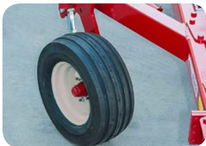
Roue de terrage arrière. Disponible en 6.00x9", 200/60 14.5", 250/65 14.5", 340/55 16" et 380/55 17"
