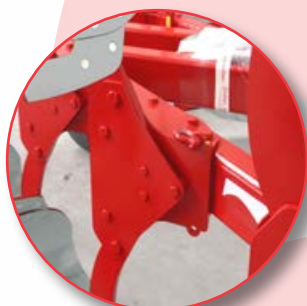
Sécurité boulon Mini-NF/NH et Mini-SF/SH
