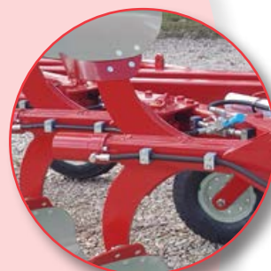
Sécurité Non Stop hydraulique (tous les modèles)
