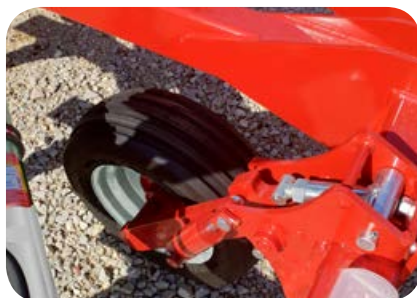
Roue de terrage avant disponible en 6.00x9", 200/60 14.5" et 250/65 14.5" (selon modèles)
