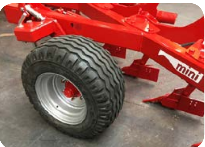
Roue de terrage et transport Disponible en 200/60 14.5", 250/65 14.5", 340/55 16" et 380/55 17"
