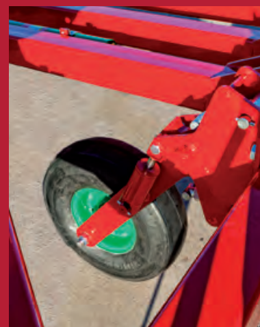
Optionnellement, on peut l'équiper d'une roue jague à l'avant pour une meilleure stabilité
