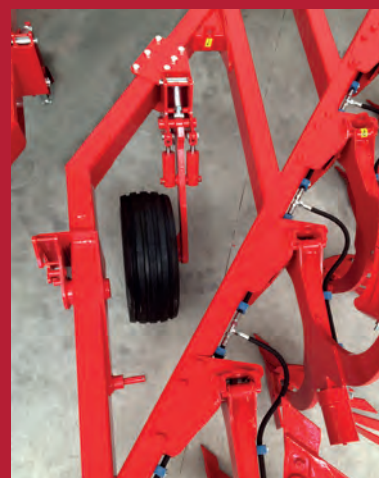
Roue jague boulonnée qui reste dans la largeur de travail de la mini
