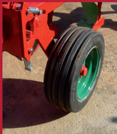
Roues jagues disponibles en plusieurs dimensions (Métalliques ou Pneumatiques)
