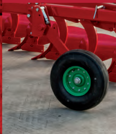
Roues jagues disponibles en plusieurs dimensions (Métalliques ou Pneumatiques)
