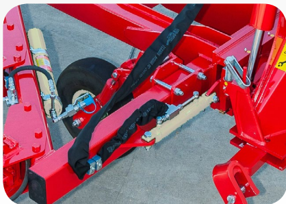
Regulación hidráulica del primer cuerpo
