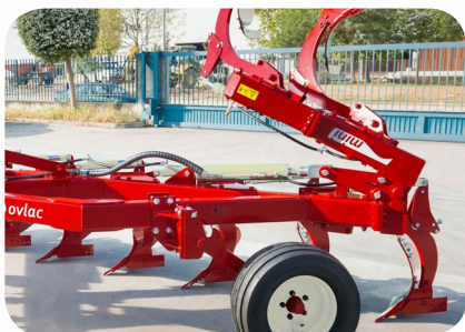
Cuerpos adicionales plegables hidráulicamente para menor peso y longitud durante el transporte (solo Mini-BF y HF)
