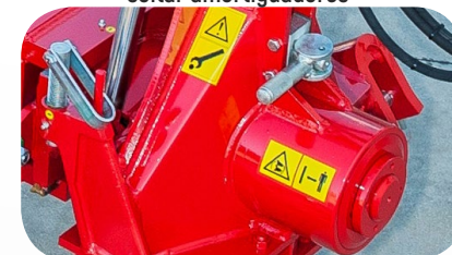
Bloqueo de cabezal para transporte en posición mariposa
