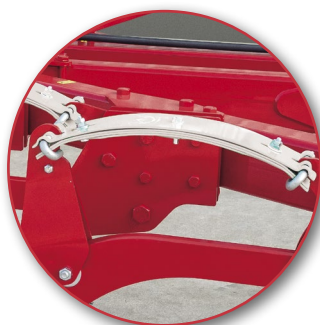
Seguridad Non Stop de ballesta: Mini-BF
