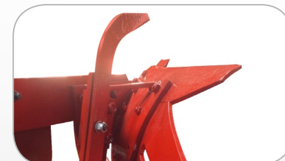
Brazos fisuradores "Pan-Cracker"
