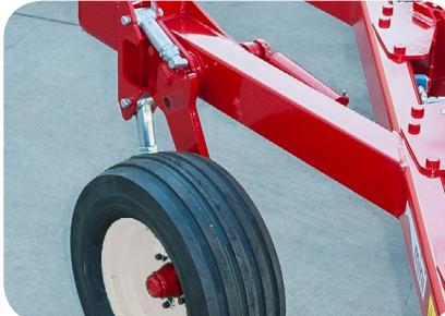
Rueda trasera de control de profundidad. Disponible en 6.00*9" (serie), 200/60 14,5", 250/65 14,5", 320/60 12", 340/55 16" y 380/55 17"
