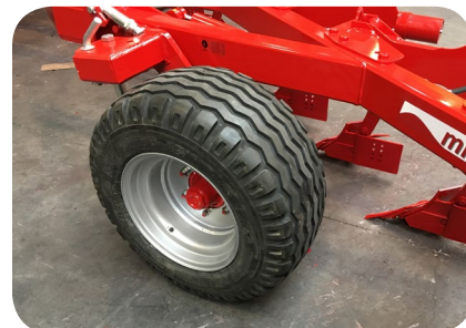
Rueda trasera de control y transporte. De gran facilidad de uso, basta cambiar un bulón de posición. Sin necesidad de bloquear topes o soltar amortiguadores
