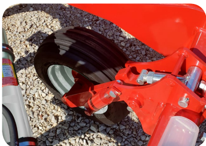
Rueda frontal de control. Disponible en 6.00*9", 200/60, 250/65 (según modelos)
