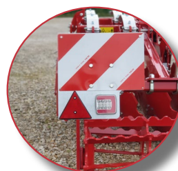
Luces de señalización para el transporte opcionales en la versión suspendida y de serie en la versión semi-suspendida.
