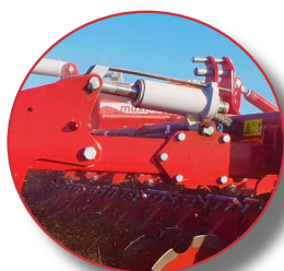
Ajuste hidráulico de la profundidad de trabajo opcional (2 cilindros de doble efecto por rodillo).
