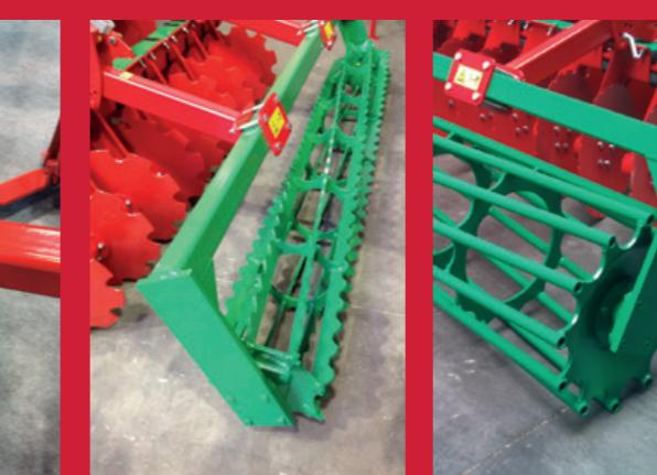
Rodillo de pletina muescada de 400 mm. Muy buen efecto desterronador en terrenos secos gracias a su alta velocidad de giro.
