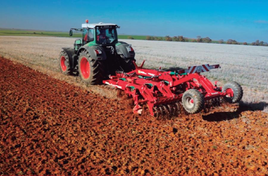
El **Versatill** de Ovlac se concibe como un **cultivador polivalente** para realizar labores primarias ya sea de **incorporación de rastrojo o de descompactación** en profundidad.
