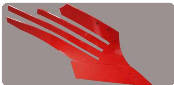
**V-LOV:** vertedera de láminas independientes. Indicada para terrenos pegajosos. Al igual que el resto de los cuerpos, utiliza tornillos cónico-ovalados.
