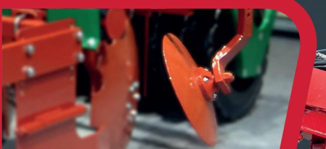
Les déflecteurs latéraux et le disque latéral limitent la projection de la terre vers l'extérieur pour assurer un nivellement homogène du sol.
