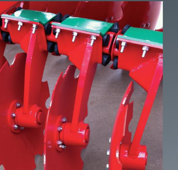
Le **Maxidisc-II** est conçu avec un bâti surdimensionné calculé pour supporter les fortes pressions dérivées de l'utilisation de disques 24" (610 mm) de diamètre. Ce même bâti a été développé également dans le but de supporter les fortes sollicitations des tracteurs de grandes puissances. Attelage catégorie II et III.
