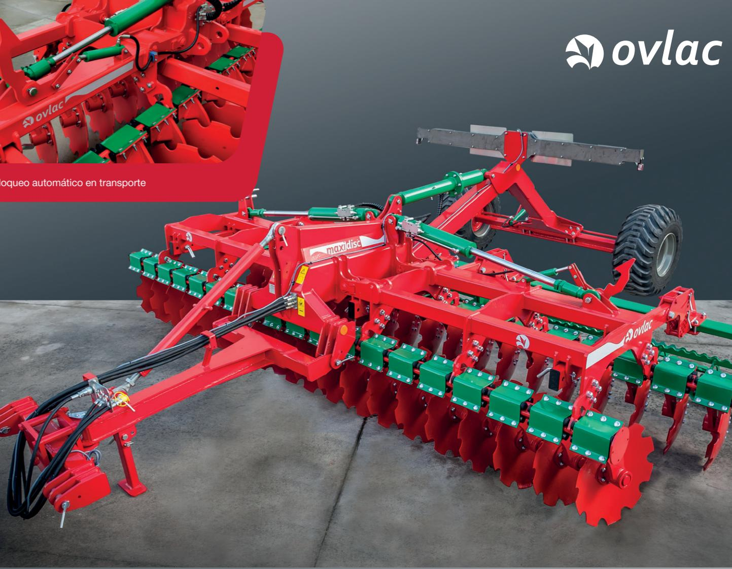
Cualquier **Maxidisc II** suspendida se puede transformar a posteriori en arrastrada gracias al Kit de Transporte. La lanza se acopla directamente a los tres puntos de la **Maxidisc II** y cuenta con enganche Categoría II/III a los brazos de levantamiento del tractor. Su altura se puede regular gracias al tirante-tensor del tercer punto. El tren trasero de ruedas está dotado de suspensión hidráulica y frenos hidráulicos.
