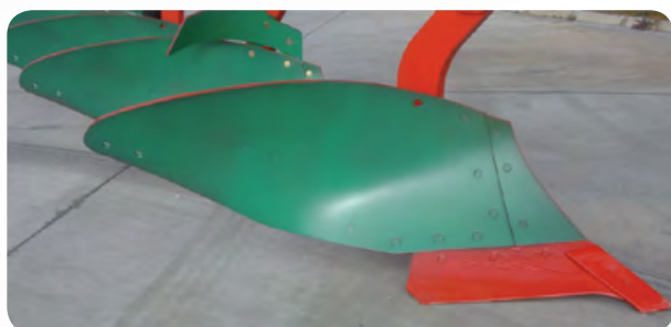
V-34: Corps universel hélicoïdal pour tous les sols. Bien adapté aux roues larges. Excellent retournement avec une faible demande de puissance. Profondeurs de 15 à 35 cm.
