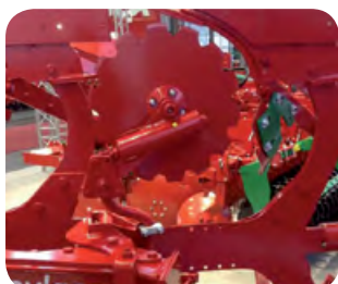
Coutres circulaires lisses ou crénelées avec systèmes Non-Stop.
