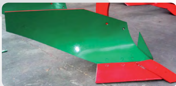
C-34: Corps cylindrique creux polyvalent pour les sols moyens et lourds et conseillé pour des profondeurs de travail entre 18 et 30 cm.
