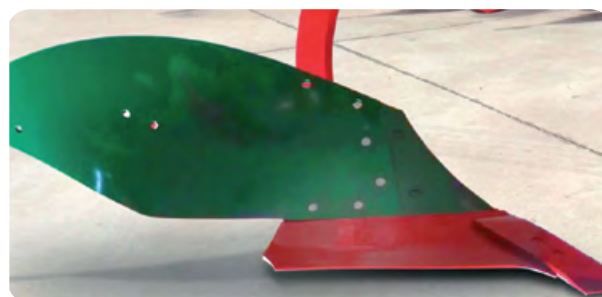
V-97: Corps universel hélicoïdal pour tous les sols. Faible demande de puissance. Profondeurs de 15 à 30 cm.
