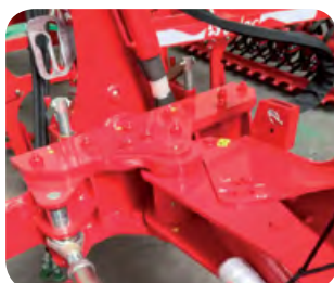
Déport du premier corps 800 mm au lieu du 600 mm de série. Aussi disponible hydrauliquement.
