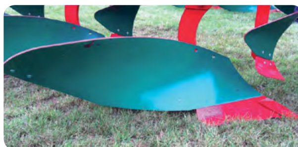
V-90: Corps hélicoïdal long pour un fond de raie bien dégagé pour des roues très larges (>760 mm). Excellent retournement grâce à sa longueur. Demande de puissance proche du V-34.
