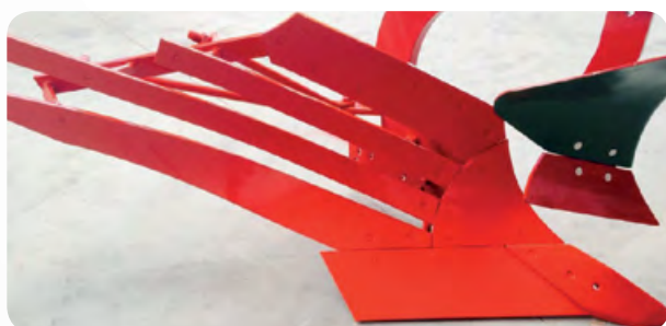
V-LOV: Versoir à claire-voie à lames indépendantes. Conseillé pour les sols collants. Monté avec des boulons coniques ovalisés.
