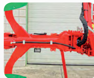
Corps X-Light 25 kg plus léger que le standard (Max 32 CV par corps). Disponible seulement pour les Séries 120 et 130.
