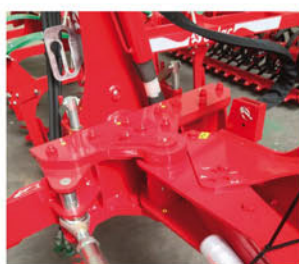
Ajuste del primer cuerpo de 800 mm en lugar de los 600 estándar. También disponible hidráulico.
