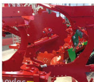
Discos cortantes lisos o dentados con seguridad Non Stop.
